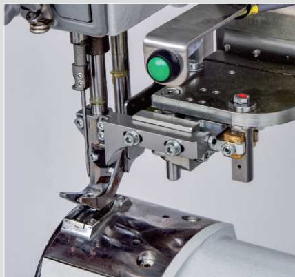
强劲稳定的切边器，适合各种硬革材料的裁切
