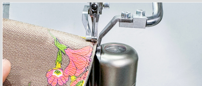
超小旋梭，能实现非常狭窄的边缘和角落的缝制
