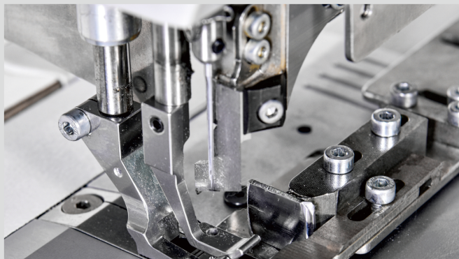
独立电机驱动的垂直式切边装置
