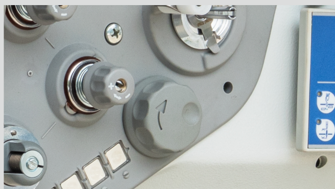
电子手轮实现轻松精准的机针定位
