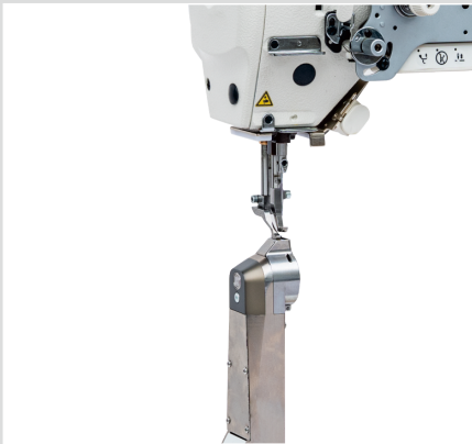
立柱和针板尺寸以最大限度缩小，能缝制极窄边缘和角落
